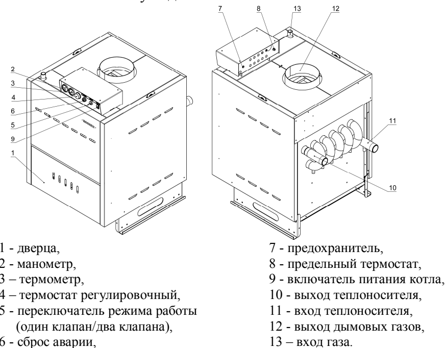
Рисунок 2. Общий вид котла
